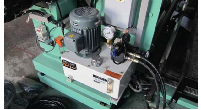
Hidrolik Aktüatör AO-2GH laminasyon makinesi geri sarma işlemi için kullanılmaktadır.
